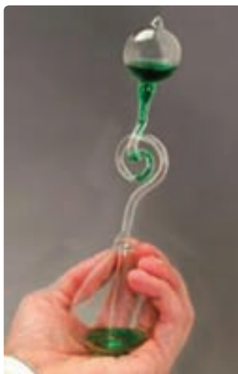
شکل ۴-۱۵ با در دست گرفتن حباب شیشه‌ای و گرم کردن آن، مایع رنگی در لوله مارپیچ بالا می‌رود.
