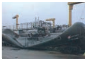
شکل ۴-۱۴ سرد شدن هوای درون مخزن باعث کاهش فشار این هوا و در نتیجه محاله شدن مخزن شده است.
