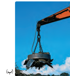
شکل ۳-۲۱ الف) سیملوله با هسته آهنی ب) آهنربای الکتریکی صنعتی
